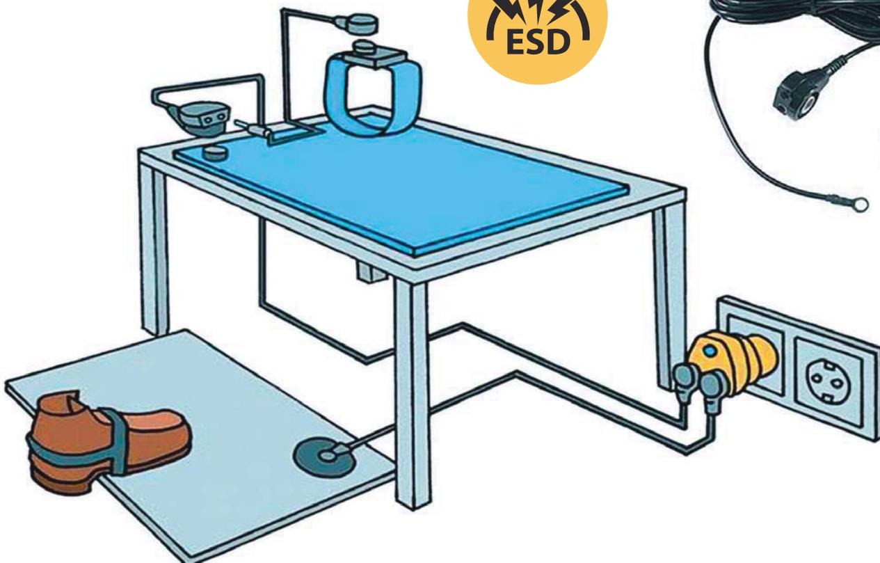
*Flexible Arbeitshilfe zur Aufrechterhaltung der statischen Kontrolle. Wird unter Computern als Tischmatte beim Umgang mit Produkten verwendet.*
